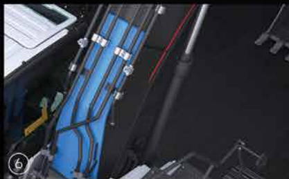
⑥ Estructura de pluma reforzada
