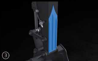
③ Componentes de sustentación del balancín reforzados
