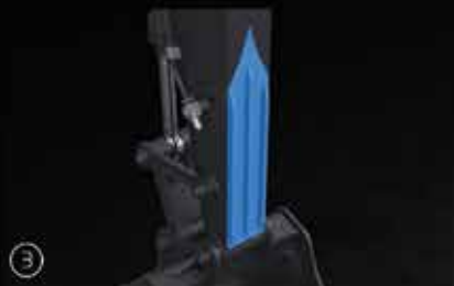
③ Componentes de sustentación del balancín reforzados
