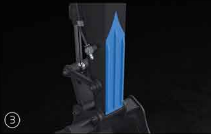
③ Componentes de sustentación del balancín reforzados
